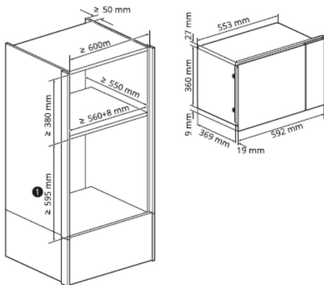
1 Se instalado com um forno encastrado LG de 24"
