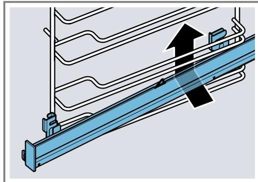
2. Conduza a calha longitudinalmente às hastes guia para trás e insira os dois suportes respetivamente na haste inferior. Para o efeito, com o suporte traseiro [b] envolva a haste vertical.
