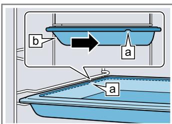
3. Grelha ou tabuleiro      Coloque o acessório de forma a que o acessório seja inserido no batente superior do sistema extensível.
