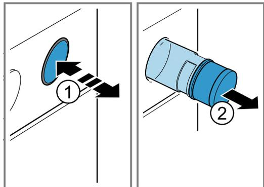
2. Pressionar a tampa do depósito de água ① e desenroscá-la ②.
