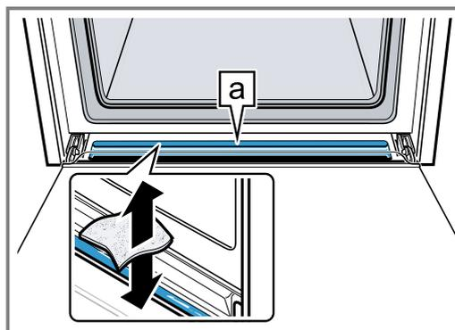
Absorver a água existente na calha com um pano esponja e limpar com cuidado.
