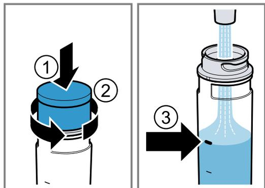
4. Pressionar a tampa do depósito de água ① e enroscá-la ②.
