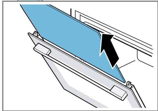
9. Se necessário, retire o friso de condensação para o limpar.
