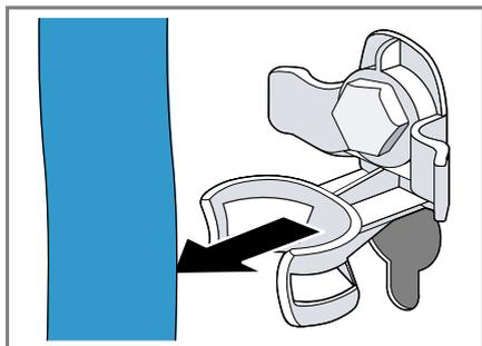
2. Aflojar ① y retirar ② todos los tornillos de los cuatro seguros de transporte con una llave de tuercas de abertura 13.
