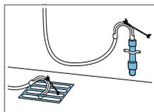
Fijar y asegurar la manguera de desagüe con un racor en codo. → "Accesorios", *Página 32*
