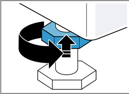
Sujetar firmemente las patas del aparato sin modificar la altura.
