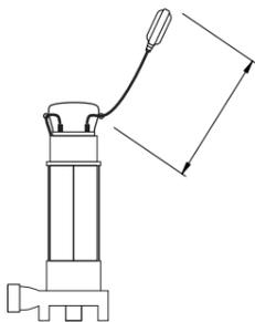
El punto de paro y arranque de la bomba puede reajustarse alargando el interruptor de boya en su dispositivo de graduación.
