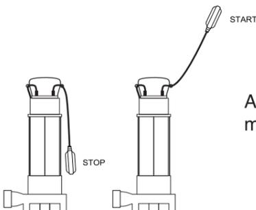
Al levantar el flotador la bomba se pondrá en marcha y al bajarlo, dejará de funcionar.
