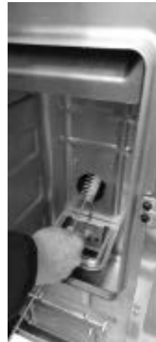
Fig. 35 - Limpieza con escobilla
