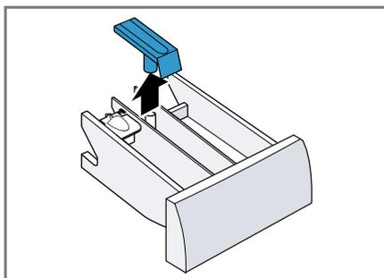
4. Lavar a gaveta para detergente e a peça de doseamento com água e uma escova e secar bem.
