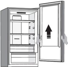
Remova a porta superior pela dobradiça do meio levantando-a cuidadosamente para cima. Coloque a porta sobre uma superfície macia.
