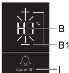
Se a temperatura no interior do eletrodoméstico for demasiado elevada, será ativado um alarme acústico (tom intermitente) e **HI** piscará na unidade de visualização **B** ou **C**, dependendo do compartimento do eletrodoméstico em que a temperatura é demasiado elevada.
