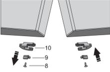
Desaperte o parafuso (8) e remova o retedor da porta (10) e a batente da porta (9). Em seguida, utilize um parafuso (8) para instalar o retedor da porta fornecido no saco e o batente da porta (9). Guarde o retedor da porta (10) caso necessite do mesmo mais tarde.
