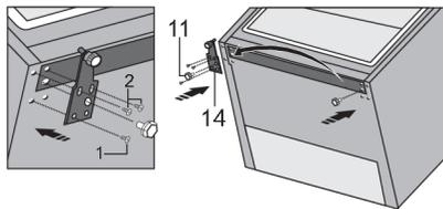
Fixar a dobradiça (14) no lado oposto com os parafusos. Os parafusos devem ser fixos pela ordem ilustrada na figura abaixo.
