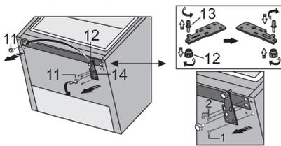
Desapertar os três parafusos na dobradiça inferior (14) e remover a dobradiça.
