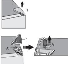
Retire a tampa da dobradiça superior (1). Tenha o cuidado de não danificar o conector (A). Desligue o conector (A).
