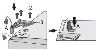
Posicione corretamente a porta superior, passe o conector (A) pelo buraco da dobradiça superior (3) e fixe-a com os parafusos (2). Mantenha a porta superior no devido lugar enquanto a posiciona. Volte a ligar o conector (A).
