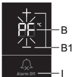
Se a temperatura do eletrodoméstico aumentar para o nível de alarme durante um corte de energia (falha de alimentação), o alarme de temperatura elevada será ativado quando a alimentação for restabelecida. O alarme acústico será ativado e **PF** piscará na unidade de visualização **B** ou **C**, dependendo do compartimento do eletrodoméstico em que a temperatura é demasiado elevada.
