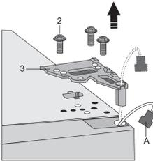
Retire os parafusos (2) e a dobradiça (3). Passe o conector (A) pelo buraco da dobradiça. Durante esta operação, segure na porta para a impedir de cair.
