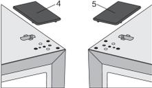
Pegue na tampa/cobertura (direita) (4) do saco e coloque-a o local de onde se retirou a dobradiça superior. Remova e guarde a tampa/cobertura do outro lado (5) onde a dobradiça será colocada.
