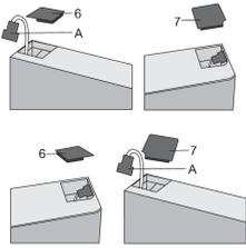
Retire o tapa-buraco (6) no lado esquerdo da porta superior e retire o conector. Retire depois o tapa-buraco (7) no lado direito da porta superior. Insira o tapa-buraco (7) no lado esquerdo da porta superior e insira o tapa-buraco (6) no lado direito da porta superior.
