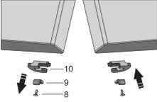
Coloque a porta inferior numa superfície macia. Desaperte o parafuso (8) e remova o retedor da porta (10) e o batente da porta (9). Em seguida, utilize um parafuso (8) para fixar o retedor da porta fornecido no saco e o batente da porta (9). Guarde o retedor da porta (10) caso necessite do mesmo mais tarde.
