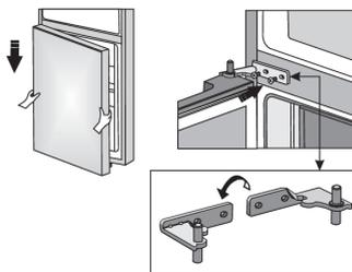
Coloque a porta inferior na dobradiça inferior e segure-as. Rode a dobradiça do meio a 180°. Coloque a arruela na posição correta e ajuste a posição da dobradiça do meio para que consiga instalar e fixar a porta inferior.
