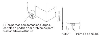
Fig. 2 Instalación de los pernos de anclaje
