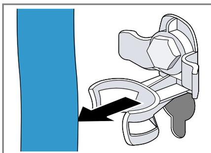
2. Solte todos os parafusos das 4 proteções de transporte com uma chave tamanho 13 ① e retire-os ②.
