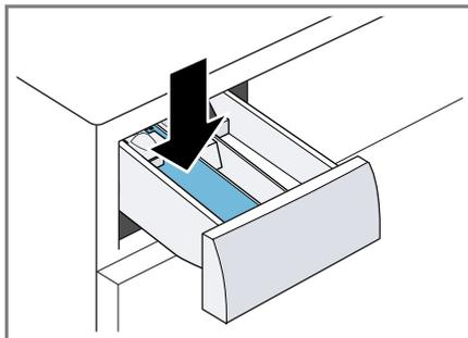
Utilize apenas metade da quantidade de detergente recomendada pelo fabricante do detergente para sujidade leve, de modo a evitar a formação de espuma. Não utilize detergente para lãs ou detergente para roupa delicada.
