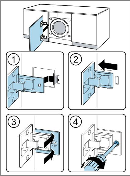
7. Insira a calha de cobertura ③ e aparafuse-a ④.
