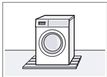
Instalar o aparelho sobre uma placa de madeira impermeabilizada (com 30 mm de espessura mínima) fixamente aparafusada ao chão.
