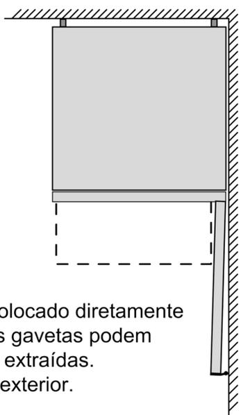
Se o aparelho for colocado diretamente na parede, todas as gavetas podem ser completamente extraídas.
