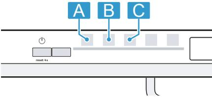
Se o LED A se acender, a função está desativada permanentemente. Se o LED A e o LED B se acenderem, a função pode ser selecionada através da tecla **▷**.
