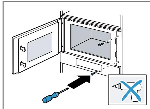
5. Abrir previamente os furos para o aparafusamento do lado das dobradiças no móvel.
