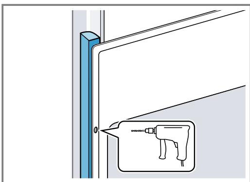
4. Fixar o aparelho com um parafuso adequado.
