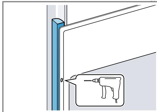
4. Fijar el aparato con los tornillos adecuados.
