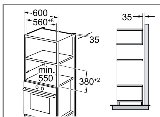
Montar o aparelho a uma altura máxima que permita retirar os acessórios sem problemas.
