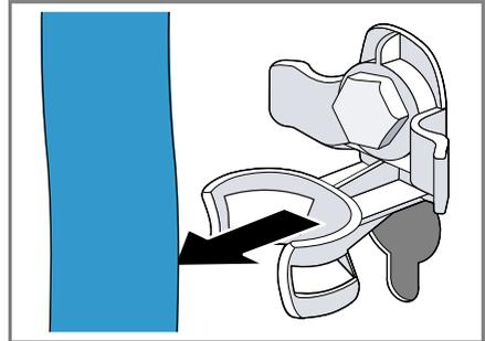
2. Solte todos os parafusos dos 4 dispositivos de segurança para transporte com uma chave SW13 ① e retire-os ②.
