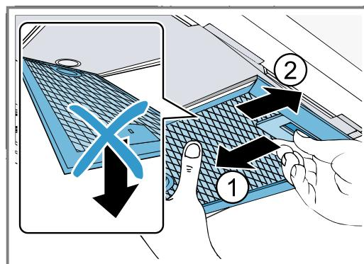
Sujetar el filtro antigrasa en posición horizontal para evitar que la grasa gotee.
