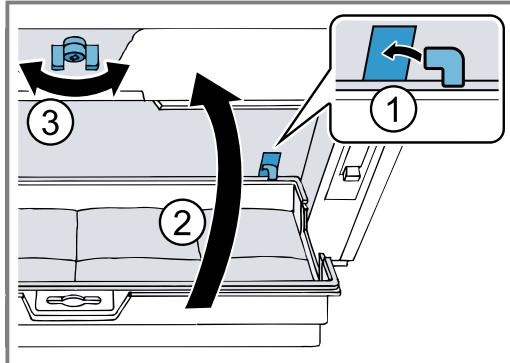
7. Se o aparelho tiver uma barra distanciadora, esta deverá ser colocada.
