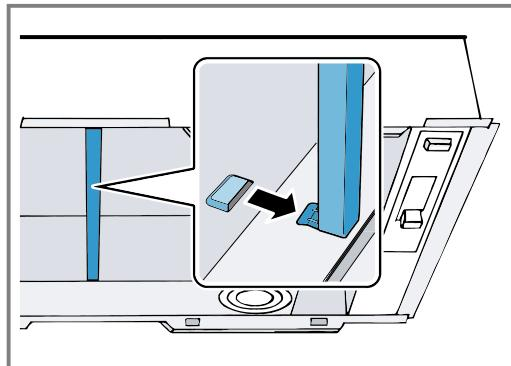
3. Use uma chave de parafusos para pressionar as duas patilhas para dentro do fundo falso.
