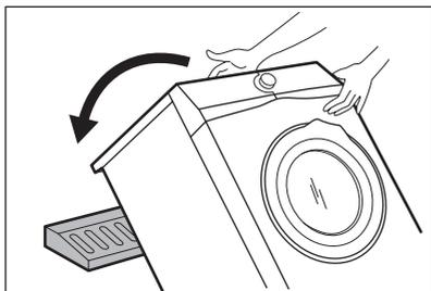
7. Retire a proteção de polistireno da parte inferior.
