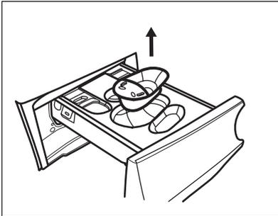
3. Levante a tampa superior dos compartimentos para removê-la.
