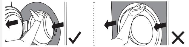
Con el traslado (movimiento) adicional, es necesario utilizar la protección para el transporte (la lavadora debe ser bloqueada) (ver sección PROTECCION PARA EL TRANSPORTE).
