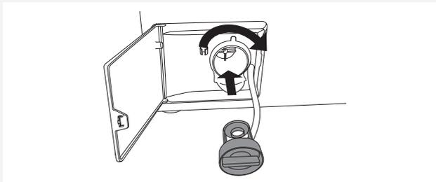
**1** Antes de la limpieza evacúe el agua de la lavadora con el programa Vaciado de agua y desconecte el aparato de la red eléctrica.
