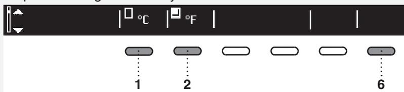
Con la tecla 1 valide el ajuste de temperatura en °C. Con la tecla 2 valide el ajuste de temperatura en °F.
