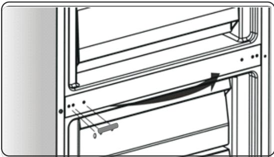
11. Incline el refrigerador hacia atrás y retire la pieza ②.
