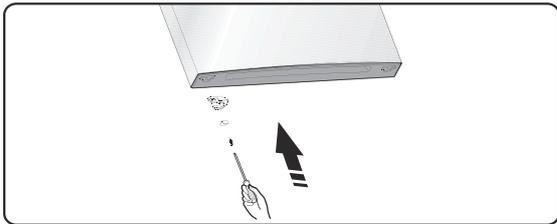
10. Cambie los cobertores de los orificios del tornillo en la placa del medio de izquierda a derecha (como se muestra en la imagen de arriba).
