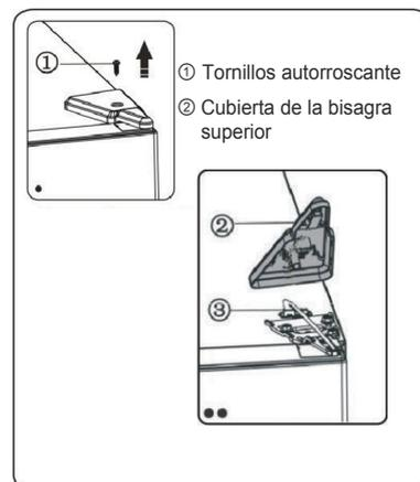
3. Retire los tornillos ① y la bisagra ②. Cuando el refrigerador con la pantalla en la puerta, debe pasar un conector ③ a través del orificio de la bisagra ② (sostenga la puerta superior con la mano cuando la instale).
