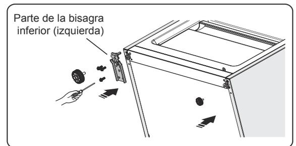
14. Posicione la puerta inferior en la clavija de la bisagra inferior y manténgala en posición. Gire la bisagra central a 180°, cambie la arandela del eje al lado inferior, sujete la bisagra central en la posición correcta y luego instálela y asegúrese que la puerta esté firme en el lugar.
