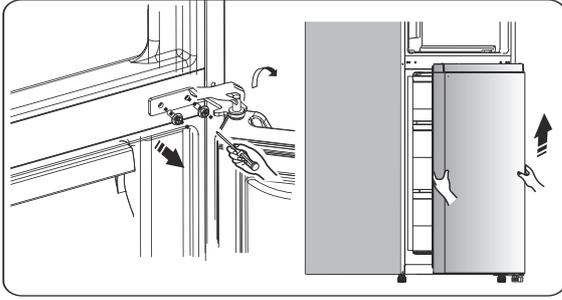
9. Coloque la puerta inferior sobre una superficie suave con los paneles hacia arriba. Afloje el tornillo ③ y quite la parte ② y la parte ①. Instale el tope izquierdo de la puerta ④ (proporcionado dentro de la bolsa de plástico) y la parte ② (tope) al lado derecho utilizando el tornillo ③. Mantenga la pieza ① con el aparato para consultas futuras.
