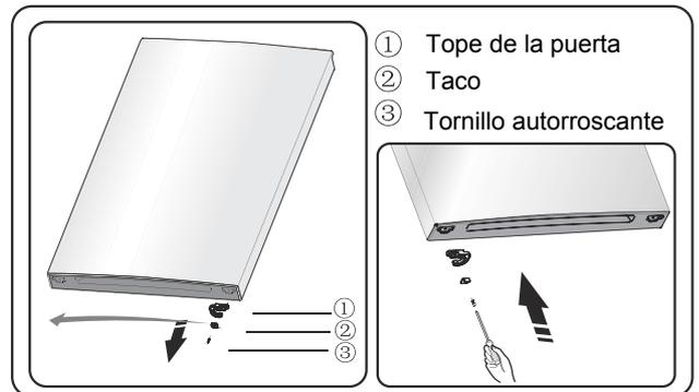
8. Afloje los tornillos utilizados para fijar la bisagra del medio y quite la bisagra. Luego, quite la puerta inferior.
