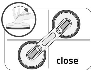
4. Pritisnite ručicu za hvatanje pritiskom u položaju za ugradnju na zid i zatvorite ručicu za pričvršćivanje. Ovime nastaje vakuum.
