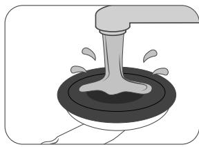
7. Eventuelt rester eller smuss på sugekoppen kan fjernes med vann og vanlig såpevann. Ikke bruk løsningsbaserte, syreholdige eller slipende rengjøringsmidler! Etter riktig rengjøring er håndtaket klart til bruk igjen. Vennligst følg trinn 1 – 5.
