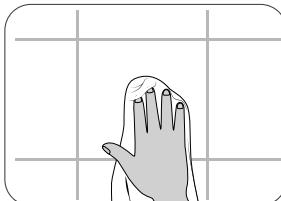
2. Nettoyez soigneusement la surface prévue pour la fixation avec un produit de nettoyage disponible dans le commerce et rendez-la absolument exempte de saleté, de poussière et de graisse.
