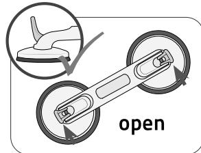
3. Enne käepideme paigaldamist veenduge, et paigalduskangid on lahti.
