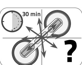
5. Før brug, skal du vente 30 minutter og med forsigtighed derefter kontrollere holdekraften igen.
