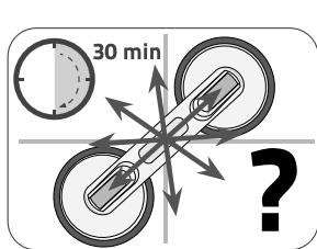
5. Před konečným užitím (zatížením z výrobku) bezpečnostních důvodů 30 minut výčkejte a opětovně vyzkoušejte pevnost uchycení.
