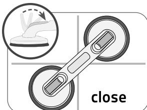
4. Dann drücken Sie den Griff mit etwas Druck an der Stelle, an der Sie ihn anbringen möchten, an die Wand und legen die Befestigungshebel um. Hierdurch entsteht das eigentliche Vakuum.
