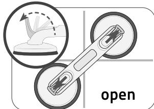
6. Para desmontar, abra as alavancas de fixação e retire a barra da parede.
