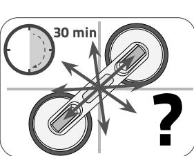
5. Înainte de a utiliza, după ce ati montat produsul, vă rugăm să așteptați 30 de minute și apoi verificați din nou puterea de reținere.
