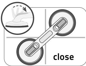
4. Presione la manija de sujeción con presión en la posición de montaje en la pared y cierre la palanca de fijación. Por la presente surge el vacío.
