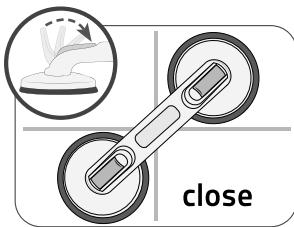
4. Затем прижмите поручень к месту крепления на стене, и закройте фиксирующие рычаги. Это создаст настоящий вакуум.
