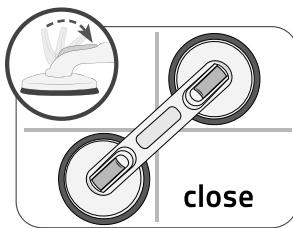
4. Paina kahva voimalla kiinnityskohtaan ja sulje kiinnitysvivut, jolloin syntyy tyhjöö.
