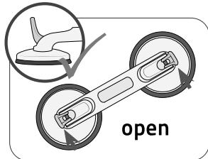
3. Zorg ervoor dat de bevestigingshendels geopend zijn voordat u de handgreep bevestigt.
