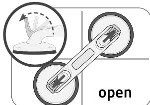
6. Om te demonteren, opent u de bevestigingshendels en verwijdert u eenvoudigweg de handgreep van de wand.
