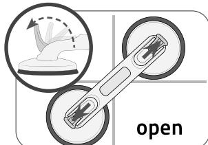
6. Pour démonter, ouvrez les leviers de fixation et retirez simplement la poignée du mur.
