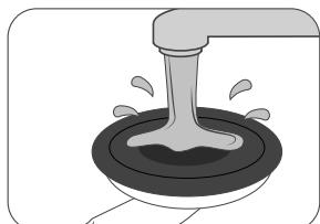
7. Vakuumske seske po demontaži očistite s toplo vodo in neagresivnimi čistili. Ne uporabljajte čistil, ki vsebujejo kisline, topila ali so abrazivna. Po ustreznem čiščenju je ročaj ponovno pripravljen za montažo po postopkih od 1-5.
