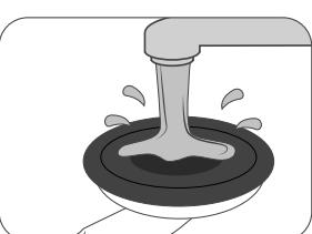
7. Los posibles residuos de suciedad o similares en la ventosa se pueden eliminar con agua y agua con jabón comercial estándar. ¡No utilice productos de limpieza a base de solventes, ácidos o abrasivos! Después de una limpieza adecuada, el asa está lista para usar nuevamente. Respete los pasos 1. - 5.
