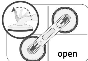
6. Pentru demontare, deschideți pârghiile de fixare și îndepărtați mânerul de prindere de pe perete.
