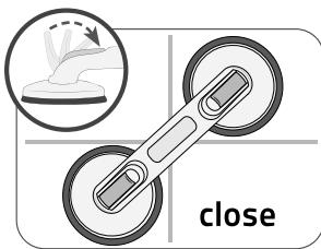
4. Premere la maniglia di bloccaggio con la pressione nella posizione di montaggio a parete e chiudere la leva di bloccaggio. Qui sorge il vuoto.
