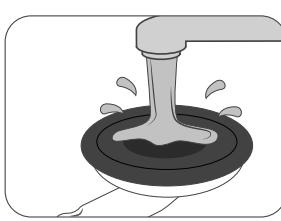
7. Evtl. Schmutz- oder sonstige Rückstände auf dem Sauger können mittels Wasser und einer handelsüblichen Seifenlauge (Auf keinen Fall hierzu lösungsmittelhaltige, säurehalteige oder scheuernde Putzmittel verwenden!) entfernt werden. Danach ist der Griff wieder einsatzbereit. Hierzu verfahren Sie bitte wieder wie unter 1. - 5. beschrieben.
