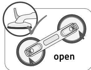
3. Asigurați-vă că pârghiile de fixare sunt deschise înainte de montare.
