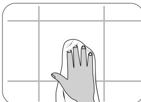
2. Mesto montaže skrbno očistite prahu in umazanje.
