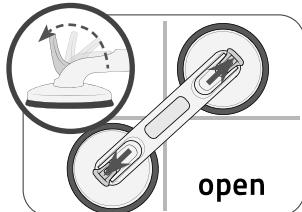
6. Při demontáži otevřete upevňovací páčky a sundejte jednoduše držák ze zdi.
