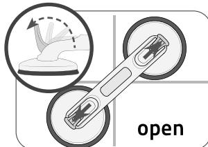
6. Irrota laite avaamalla kiinnitysvivut ja ota imukuppikahva pois seinästä.
