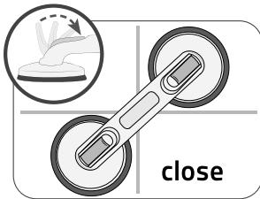
4. Druk de handgreep vervolgens op de plaats waar u de hem wilt bevestigen. Druk de bevestigingshendels dicht. Dit creëert het eigenlijke vacuüm.
