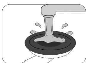
7. Eventuální špínu a nebo jiné nečistoty na přísavce můžete vodou o mydlelem odstranit. (V žádném případě nepožívejte přípravky na bázi rozpouštědel, kyselé nebo abrazivní prostředky) poté je držák opět připraven k použití. Ríd'te se opět předchozími body 1-5
