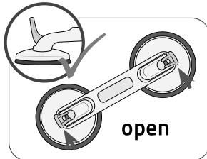
3. Asegúrese de que las palancas de fijación estén abiertas, antes del montaje.
