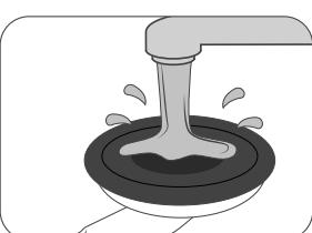
7. Eventualne ostatke prljavštine ili sličnog na usisnoj čašici mogu se ukloniti vodom i uobičajenom komercijalnom vodom sa sapunom. Ne koristite sredstva za čišćenje na bazi otapala, kisela ili abrazivna! Nakon pravilnog čišćenja, hvataljka je ponovo spremna za upotrebu. Molimo poštujte korake 1. - 5.
