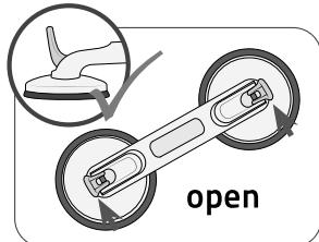
3. Se till att monteringsspacarna är öppna innan handtaget monteras.
