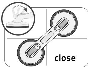
4. Namestite in pritisnite vakuumsko ročico na izbrano in očiščeno mesto pritrditve in zaprite ročice, da ustvarite ročaj.
