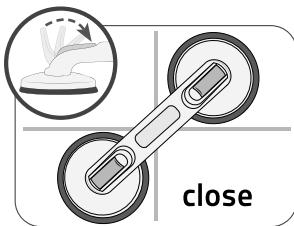
4. Apăsați mânerul de apucare cu presiune în poziția de montare pe perete și închideți maneta de fixare. Prin aceasta apare vidul.
