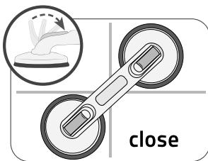
4. Appuyez ensuite la poignée contre le mur en exerçant une légère pression au point où vous souhaitez la fixer et en actionnant les leviers de fixation. Cela crée le vide réel.
