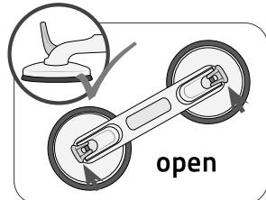
3. Pred montažo preverite ali so ročice držala (vakuma) pravilno in dovolj odprte.
