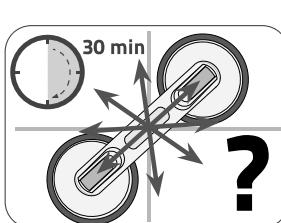
5. Som försiktighetsåtgärd vänta en halvtimme innan slutlig användning (last) av produkten och kontrollera fast fasthållning igen.
