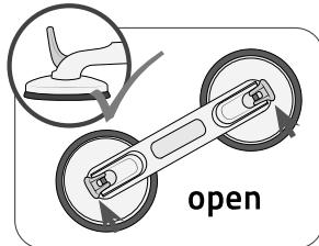
3. Přesvědčte se před upevněním držáku, že jsou upevňovací páčky otevřeny.
