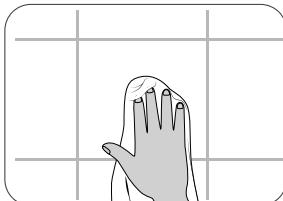
2. Тщательно очистите поверхность, подлежащую закреплению, с помощью имеющегося в продаже чистящего средства и сделайте ее полностью очищенной от грязи, пыли и жира.
