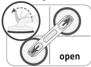
6. Zur Demontage öffnen Sie die Befestigungshebel und nehmen den Griff einfach von der Wand.
