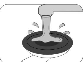
7. Eventuelle rester af snavs eller ligende på sugekoppen kan fjernes med vand og almindelig sæbevand. Brug ikke opløsningsbaserede, syreholdige eller slibende rengøringsmidler! Efter ordentlig rengøring er gribehåndtaget klar til brug igen. Overhold venligst trin 1. - 5.
