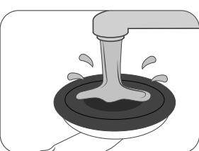
7. Possíveis resíduos de sujidade ou similares na ventosa podem ser removidos com água e sabão. Não use produtos de limpeza abrasivos ou à base de solvente! Após a limpeza adequada, a barra de apoio está pronta para uso novamente. Por favor, respeite as etapas 1. a. 5.
