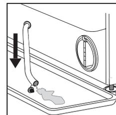
3. Girar el mango del filtro de salida y retirarlo del alojamiento. Cuando el recipiente del plinto esté lleno de agua, bloquear el extremo de la manguera y reintroducir la manguera en la base de la lavadora. Vaciar el recipiente.
