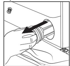
5. Limpiar el filtro del agua: eliminar los residuos del filtro y limpiarlo bajo el agua corriente.
