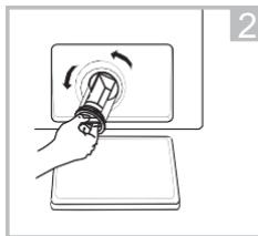
Abrir el filtro girando en sentido antihorario
