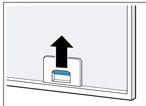
2. Retirar los filtros antigrasa de las sujetaciones. Sujetar los filtros antigrasa en posición horizontal para evitar que la grasa gotee.
