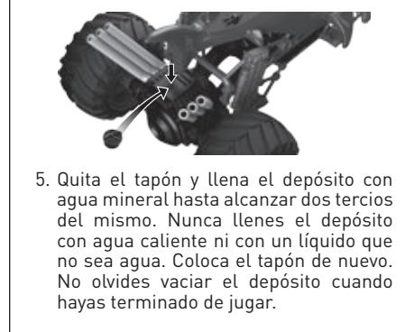
5. Quita el tapón y llena el depósito con agua mineral hasta alcanzar dos tercios del mismo. Nunca llenes el depósito con agua caliente ni con un líquido que no sea agua. Coloca el tapón de nuevo. No olvides vaciar el depósito cuando hayas terminado de jugar.
