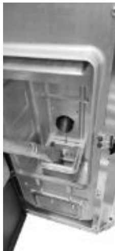
Fig. 35 - Limpieza alojamiento brasero
