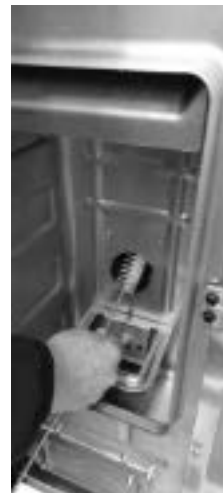
Fig. 36 - Limpieza con escobilla
