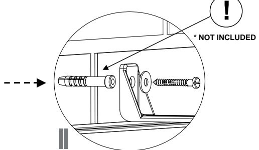
Utilizzare le viti "Vs" e le rondelle "Rs" in dotazione per fissare la squadretta "Sts" al tettuccio dell'armadio (fig I). Successivamente fissare la squadretta "Sts" alla parete (fig II). Per il fissaggio al muro utilizzare viti\* e tasselli\* adeguati alla tipologia di parete a disposizione \* NOT INCLUDED
